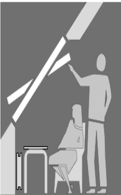
Les fenêtres à rotation se manoeuvrent en partie haute, offrant ainsi une grande liberté d'aménagement de la pièce.
